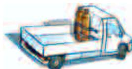
Arrimez vos bouteilles solidement dans votre véhicule, en position verticale. Une bouteille couchée dans un coffre peut devenir un projectile dangereux en cas de choc ou de tonneaux.
