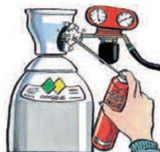
Testez l'étanchéité avec le "1 000 bulles"
