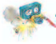
Vérifiez la bonne connexion entre le détendeur et la sortie bouteille
